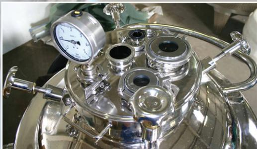
Elektropolieren ist ein elektrochemisches Verfahren zum Feinpolieren der metallischen Oberflächen. Beim Elektropolieren wird das Werkstück in ein temperiertes Elektrolytbad getaucht. Unter Einfluß von elektrischem Gleichstrom werden mikroskopisch kleine Partikel (Metallpartikel) von der Werkstoffoberfläche abgetragen.
