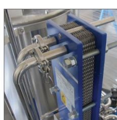
Nach dem Whirlpooling muss die Würze auf eine für die Fermentation geeignete Temperatur abgekühlt werden. Das geschieht beim Durchgang durch den Plattenwärmetauscher während des Umpumpens der Würze in den Gärbehälter.
