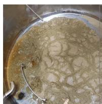
Nach dem Kochen müssen die Trübstoffe aus der Lösung entfernt werden. Die heiße Würze wird im Behälter tangential eingepumpt. Aufgrund der dadurch entstehenden Drehbewegung sammeln sich die festen Bestandteile in der Mitte des Tankbodens.
