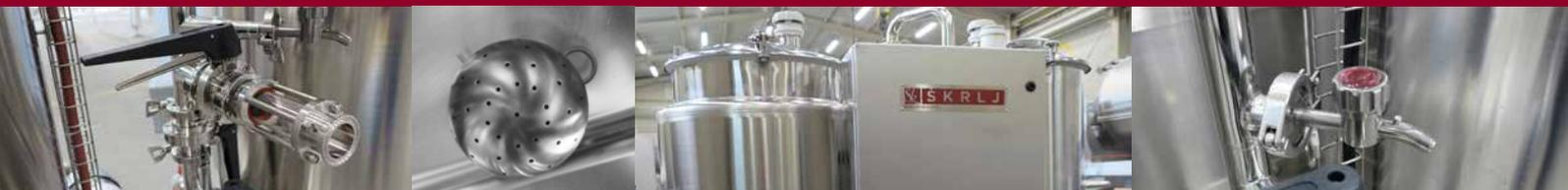
**La technologie CIP (Clean-In-Place)** est un processus de nettoyage d'équipement standard dans l'industrie alimentaire. L'avantage principal du nettoyage CIP est qu'il permet le nettoyage et la désinfection des équipements de traitement sans démontage des composants.
